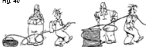
Forkert udtagning af ståltov fra kvejl og tromle
