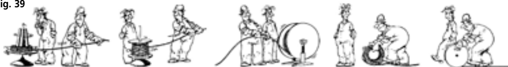
Korrekt udtagning af ståltov fra kvejl og tromle
